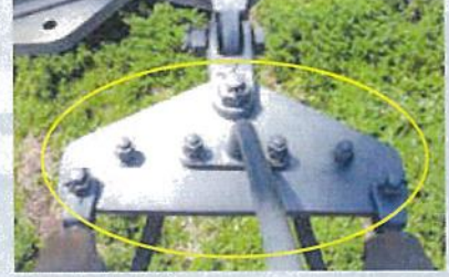
送電架線金物
